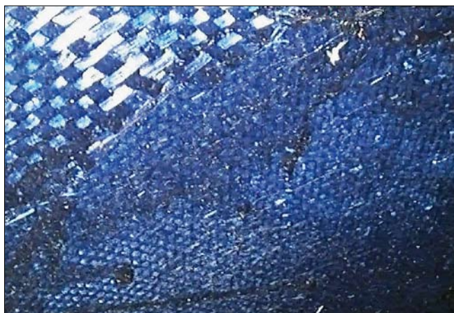
Obr. 11: Endoskopický průzkum – rub laminátu s autentickou barevností z roku 1961, snímek z roku 2015 (foto M. Tkáč).
